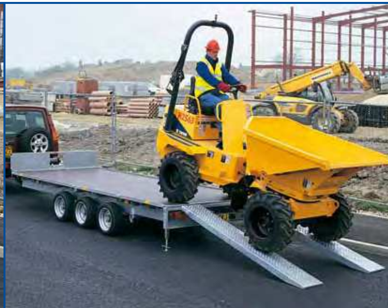
LM166 Dreiachser mit optionaler Stirnwand, elektrischer Seilwinde, Auffahrschienen und Ladestützen (Zubehör), Zurrgurte (Zubehör)
